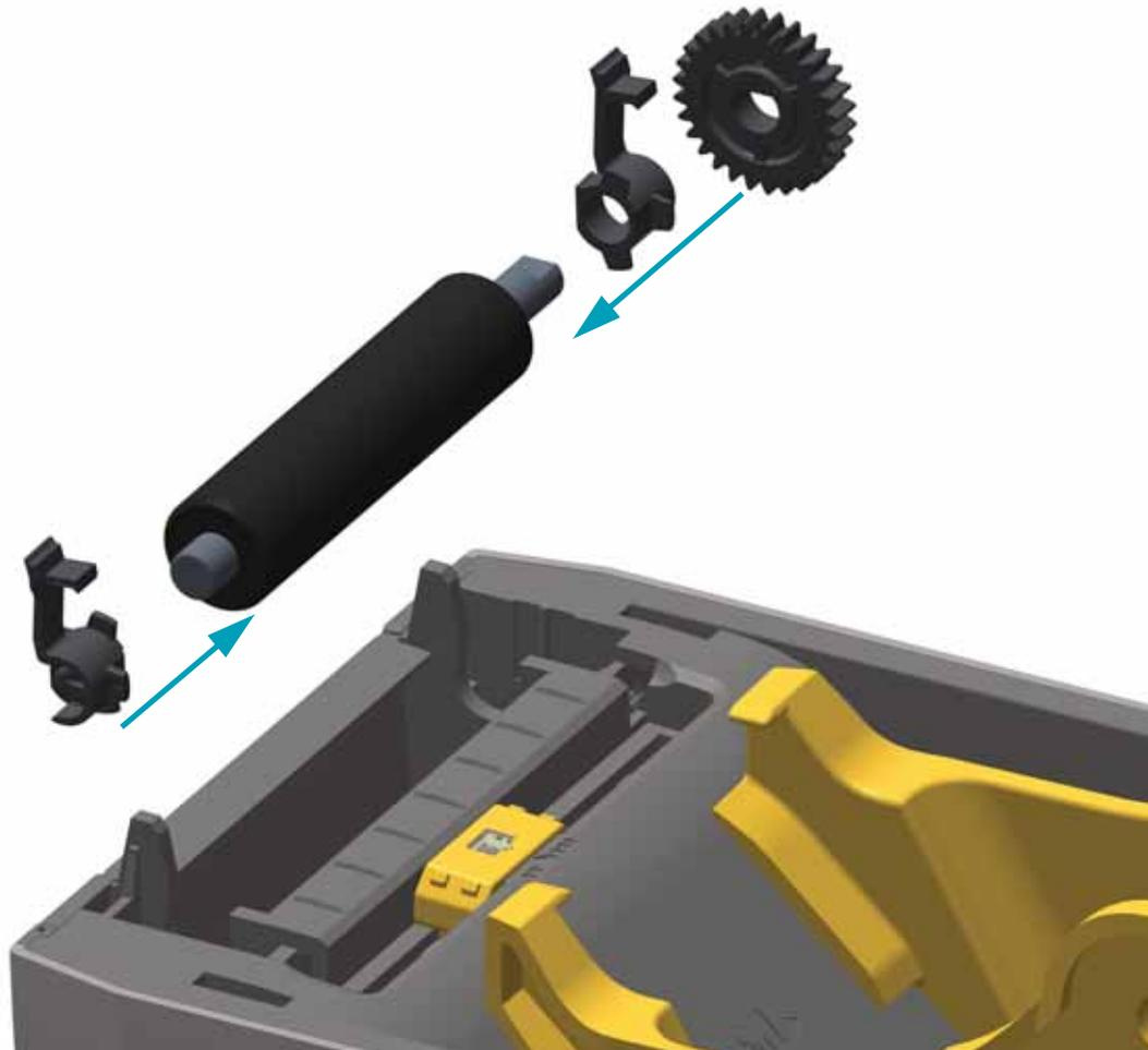
8. Halten Sie die Walze so, dass sich das Zahnrad auf der linken Seite befindet, und setzen Sie sie in den unteren Druckerrahmen ein.
