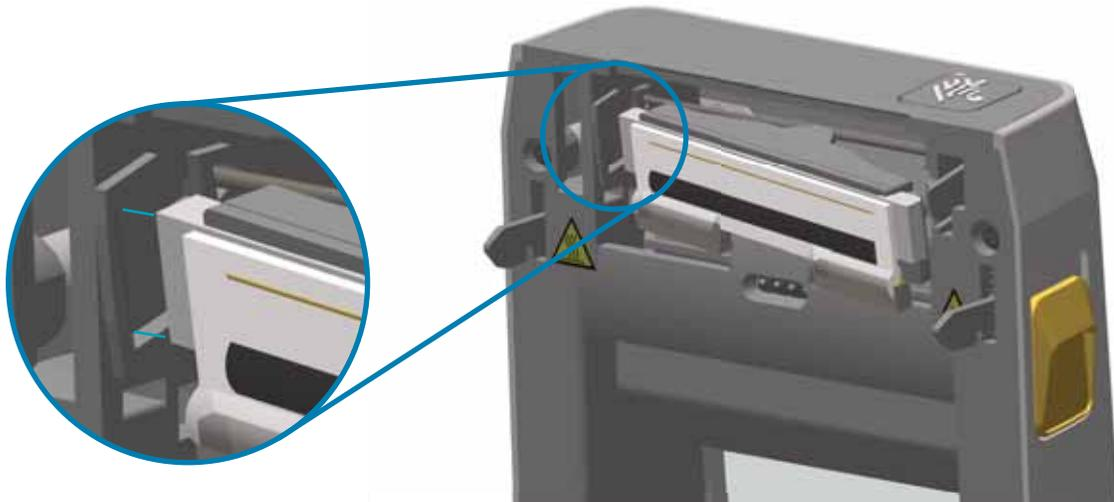
6. Drücken Sie die rechte Seite des Druckkopfes in den Drucker, bis der Hebel einrastet und der Druckkopf fest sitzt.
