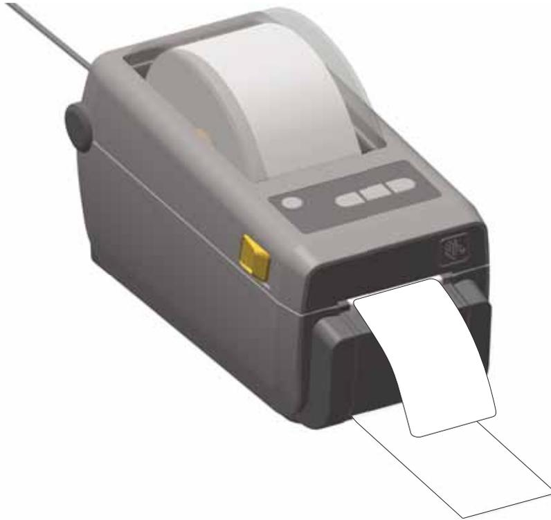
6. Beim Drucken zieht der Drucker das Trägermaterial ab und gibt ein einzelnes Etikett aus. Wenn das Etikett abgezogen wird, druckt der Drucker das nächste Etikett. Hinweis: Wenn Sie den Sensor für abgelöste Etiketten nicht über die entsprechenden Softwarebefehle aktiviert haben, werden die abgezogenen Etiketten vom Drucker gestapelt und ausgeworfen.
