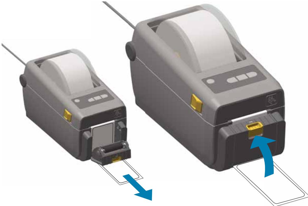
5. Drücken Sie die Vorschubtaste und lassen Sie sie wieder los (einmal oder mehrmals), bis ein Etikett zum Entfernen ausgegeben wird. Wiederholen Sie den Vorgang ein weiteres Mal, und reißen Sie das freigelegte Trägermaterial ab, das unten am Etikettenspender ausgegeben wird.
