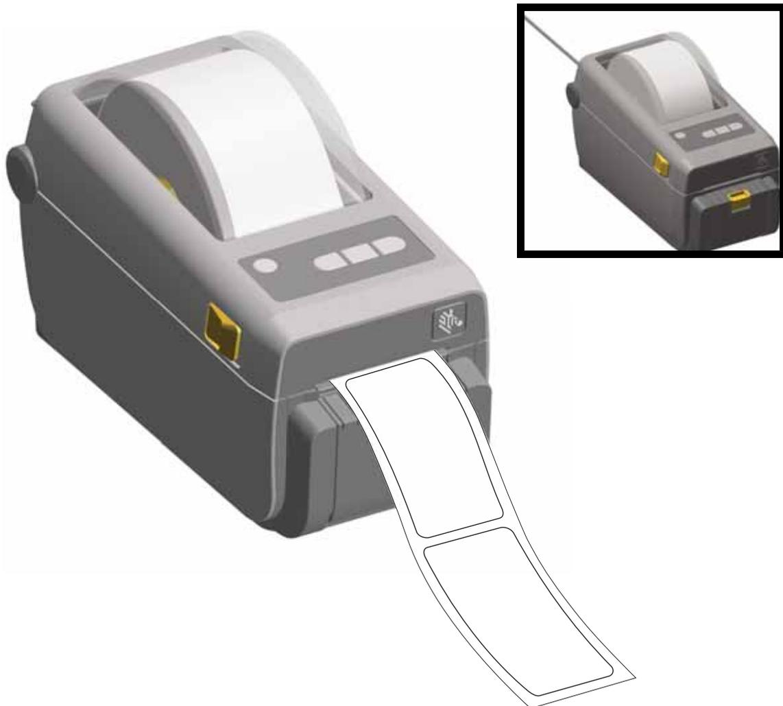
2. Ziehen Sie das Trägermaterial über die Oberseite des Druckers. Ziehen Sie am goldenen Hebel in der Mitte der Klappe des Etikettenspenders, um die Klappe zu öffnen.
