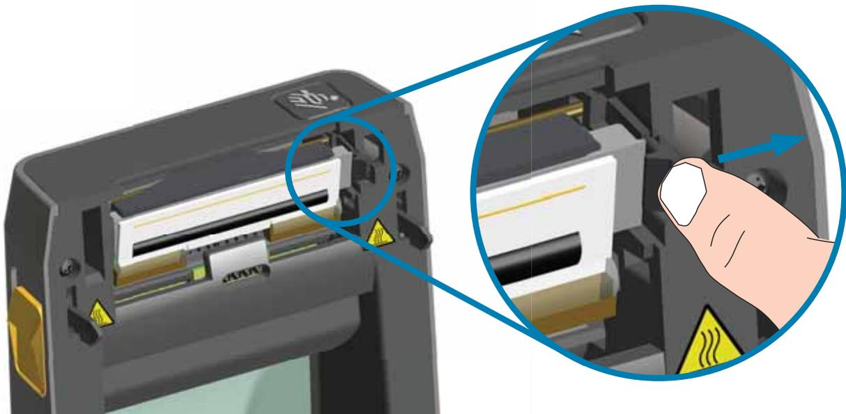
3. Drehen Sie die gelöste rechte Seite des Druckkopfes aus dem Drucker heraus. Ziehen Sie den Druckkopf etwas zur rechten Seite, um die linke Seite des Druckkopfes zu lösen. Ziehen Sie den Druckkopf heraus, um auf die angeschlossenen Kabel zugreifen zu können.
