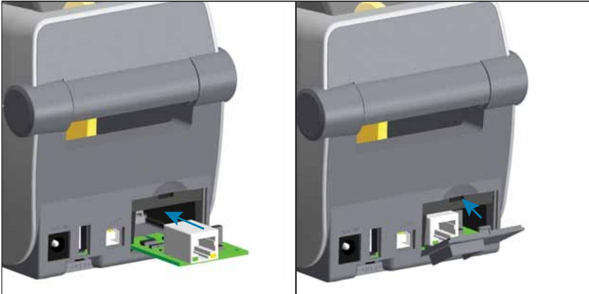
1. Schieben Sie nach dem Entfernen der Zugriffsklappe das serielle Anschlussmodul in den Drucker. Schieben Sie die Bus-Leiterplatte langsam, aber mit Druck in das Gerät, bis die Leiterplatte am Innenrand der Zugriffsoffnung anliegt.
