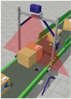
Typical Dimensioning Arrangement / Configuration de mesure typique
