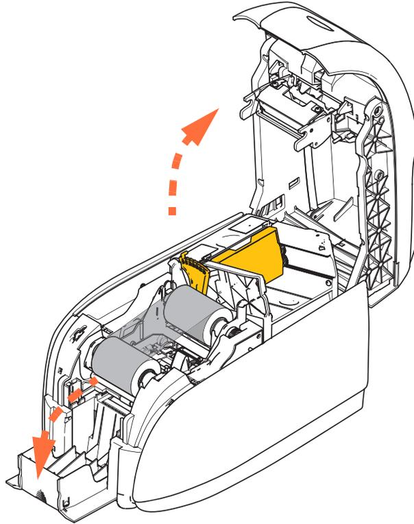
**Schritt 3.** Wenn der Drucker nicht in Betrieb ist, sollten Sie das Kartenausgabefach schließen, um den Drucker vor Staub zu schützen.
