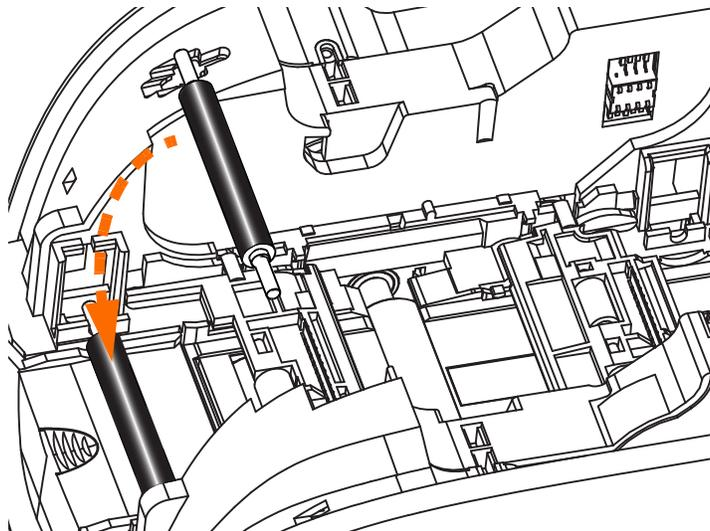
**Schritt 4.** Während Sie die Walze herunterdrücken, schalten Sie den Netzschalter EIN. Wenn die Walze in der Halterung einrastet, hören Sie ein lautes Klicken.
