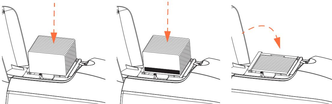
**Schritt 9.** Schließen Sie die Abdeckung des Karteneingabefachs. Beim Schließen der Abdeckung löst sich der Spermmechanismus der Kartenführung automatisch.
