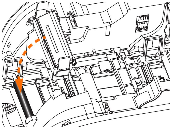
**Schritt 10.** Setzen Sie die Farbbandpatrone mit der Reinigungswalze nach unten ein, sodass sich die Antriebsmechanismen an den Enden der Walzen in die entsprechenden Vertiefungen einpassen.
