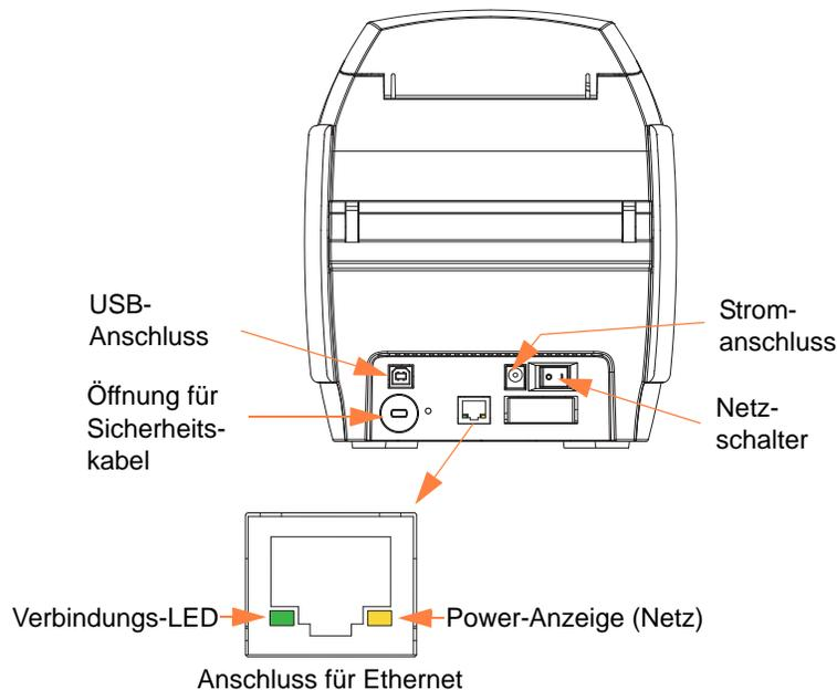
Der Ethernetanschluss verfügt über zwei LED-Statusleuchten:
