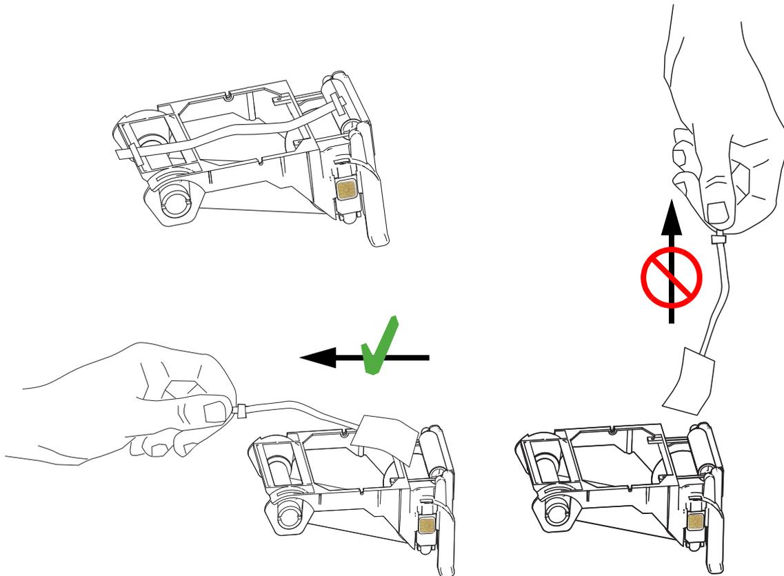
**Schritt 3.** Setzen Sie die Farbbandpatrone mit der Reinigungswalze nach unten so ein, dass sich die Antriebsmechanismen an den Enden der Walzen in die entsprechenden Vertiefungen einpassen.
