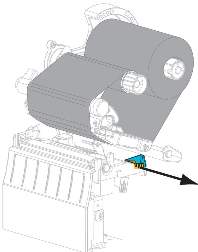
13. Schieben Sie die Medien unter die Medientänzeinheit und den Druckmechanismus. Schieben Sie das Medium so weit hindurch, dass es aus der Vorderseite des Druckers herausragt.
