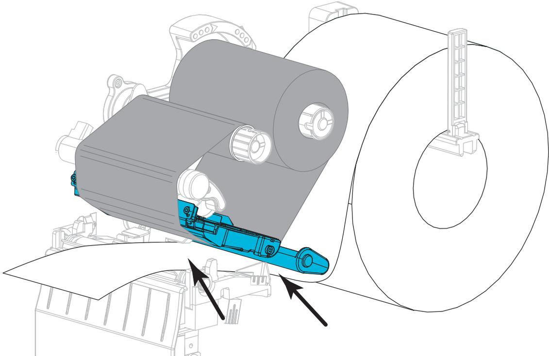
14. Stellen Sie sicher, dass das Medium durch den Schlitz im Durchlichtsensor (1) und unter der inneren Medienrandführung (2) durchgeführt ist. Das Medium sollte das hintere Ende des Schlitzes am Durchlichtsensor gerade berühren.
