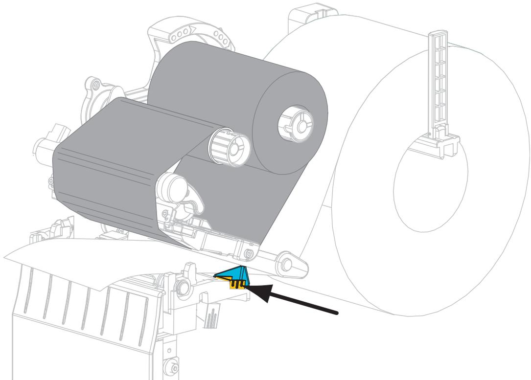
16. Drehen Sie den Hebel zum Öffnen des Druckkopfes im Uhrzeigersinn, bis der Druckkopf einrastet.
