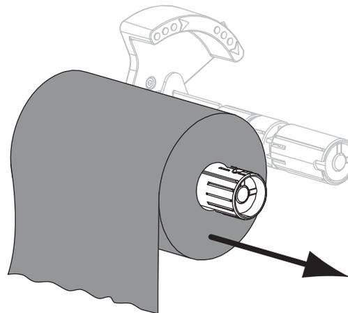
3. Entsorgen Sie das verbrauchte Farbband. Sie können den leeren Kern von der Farbband-Vorratsspule wiederverwenden, indem Sie ihn auf die Farbband-Aufwickelspule setzen.
