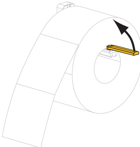
11. Schieben Sie die Führung für die Medienzufuhr so weit ein, bis sie den äußeren Rand der Medienrolle berührt.
