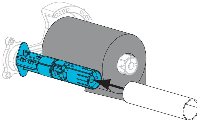
5. Schieben Sie das Farbband unter den Druckmechanismus.
