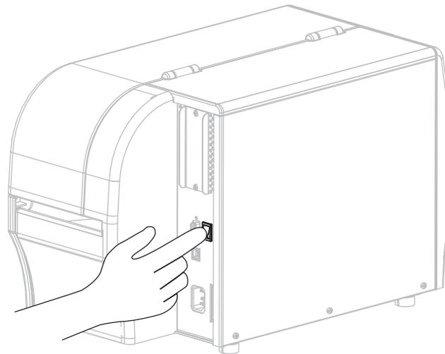
Der Drucker wird hochgefahren und führt einen Selbsttest aus. Die Ergebnisse des Selbsttests werden in [Tabelle 1](#) angezeigt.
