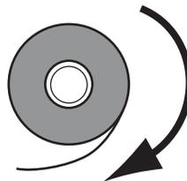
3. Setzen Sie die Farbbandrolle auf die Farbband-Vorratsspule. Drücken Sie die Rolle so weit wie möglich nach hinten.
