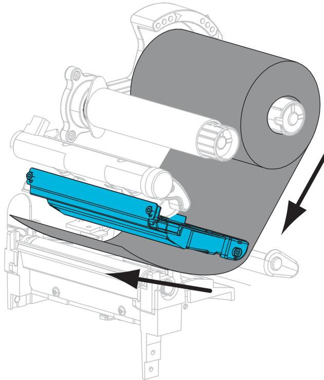
6. Wickeln Sie das Farbband im Uhrzeigersinn um den Kern auf der Farbband-Aufwickelspule. Drehen Sie die Spule, bis das Farbband mehrere Male um die Spule gewickelt ist.
