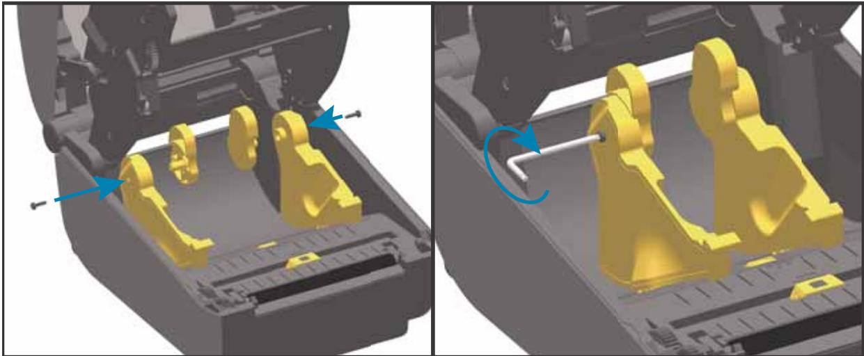
2. Platzieren Sie den Adapter an der Innenseite der Rollenhalterung. Die größere Seite des Adapters befindet sich oben. Die glatte Seite zeigt Richtung Mitte des Druckers.
