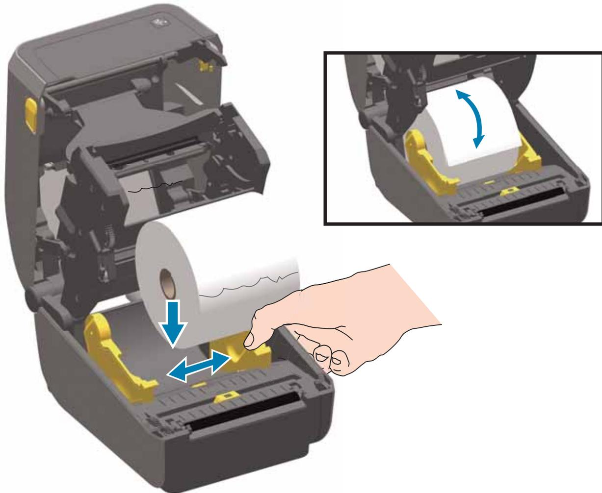
3. Ziehen Sie das Medium so weit hindurch, dass es aus der Vorderseite des Druckers herausragt.
