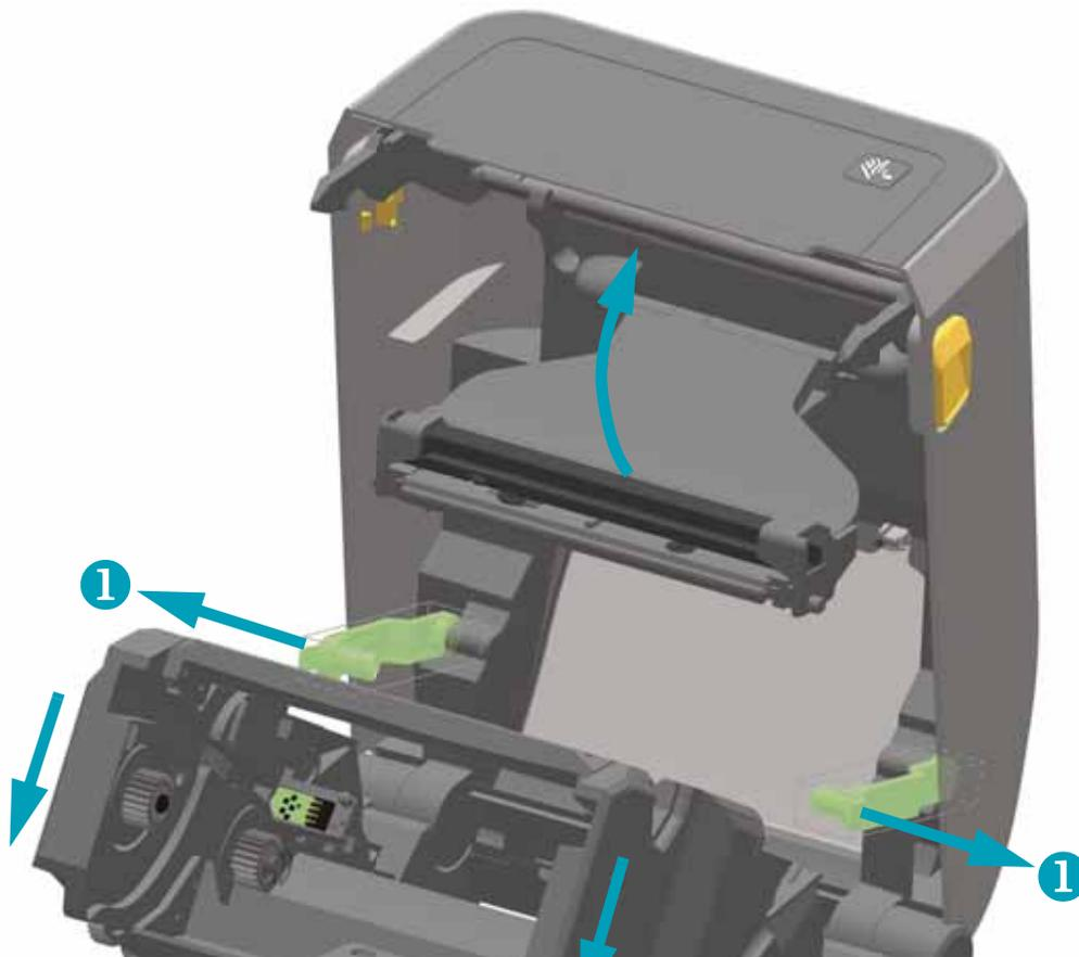
3. Schwenken Sie den Druckkopf-Auslöserarm nach oben, bis er die obere Druckerabdeckung berührt. Halten Sie den Druckkopf-Auslöserarm in dieser Position, um Zugriff auf den Druckkopf zu erhalten (siehe folgende Abbildung).
