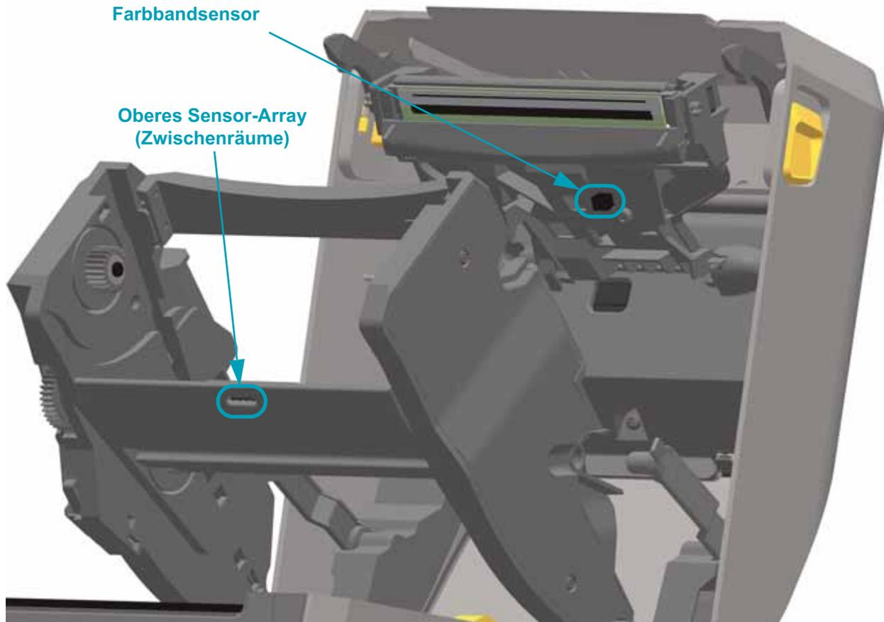
4. Reinigen Sie das Fenster des beweglichen Sensors. Entfernen Sie den Staub mithilfe eines trockenen Tupfers oder einer Druckluftdose. Hartnäckige Klebstoffe oder andere Rückstände können Sie mithilfe eines mit Ethanol befeuchteten Stäbchens lösen.
