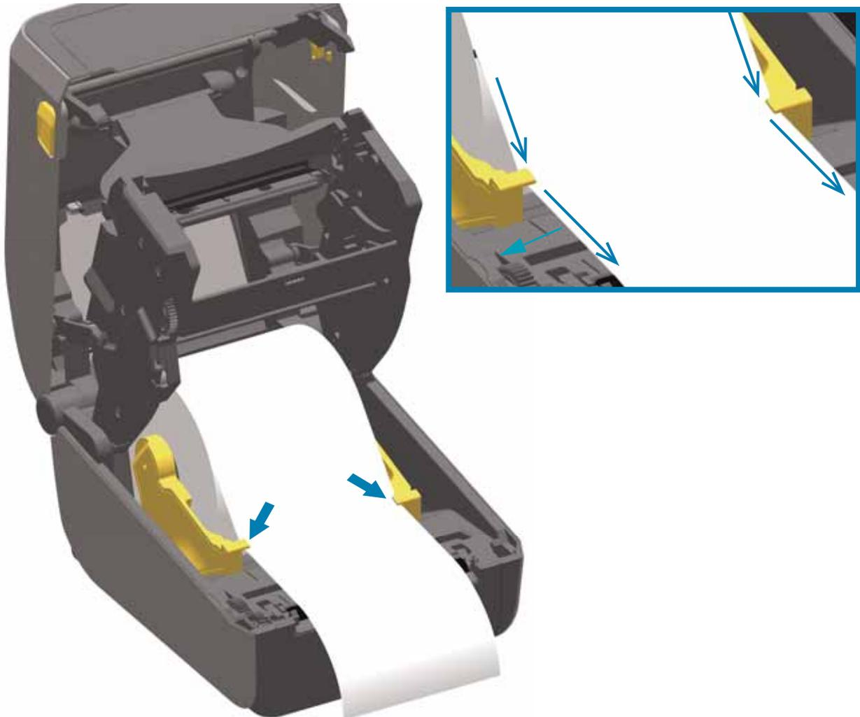
5. Drehen Sie das Medium nach oben, und richten Sie den beweglichen Sensor für den entsprechenden Medientyp aus.
