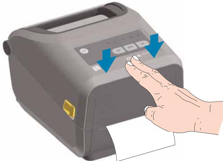
Eventuell müssen Sie den Drucker für die Medien kalibrieren. Die Druckersensoren müssen angepasst werden, um das Etikett, das Trägermaterial und den Abstand zwischen den Etiketten abtasten zu können, damit der Drucker korrekt arbeitet. Beim erneuten Laden desselben Medienformats (Größe, Anbieter und Charge) können Sie einfach die Vorschubtaste einmal drücken, um die Medien für den Druckvorgang vorzubereiten.
