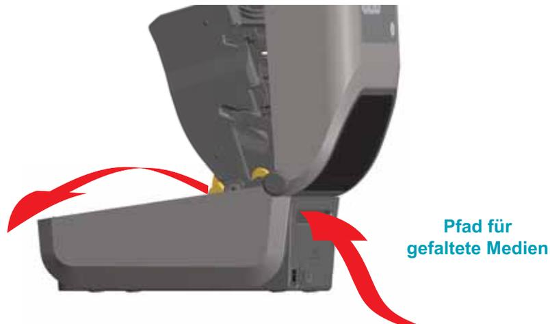
2. Passen Sie die Stoppstellung der Medienführung mithilfe des goldenen Einstellrads an. Legen Sie die Stoppstellung mithilfe eines Streifens der gefalteten Medien fest. Wenn Sie das Einstellrad in Richtung der Druckerrückseite drehen, wird die Medienführung breiter. Durch Drehen des Einstellrads in die andere Richtung wird die Medienführung schmaler.
