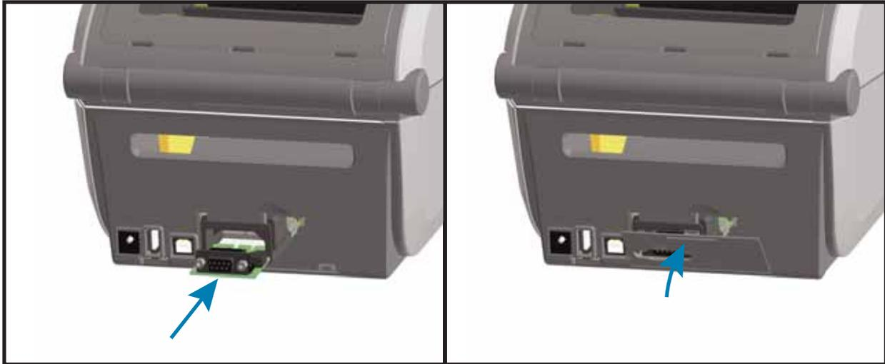
1. Schieben Sie nach dem Entfernen der Zugriffsklappe das serielle Anschlussmodul in den Drucker. Schieben Sie die Bus-Leiterplatte langsam, aber mit Druck in das Gerät, bis die Leiterplatte am Innenrand der Zugriffsöffnung anliegt.
