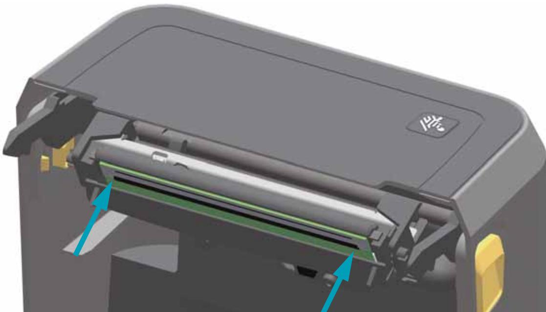
7. Verwenden Sie einen neuen Reinigungsstift, um Schmutz und Fettrückstände (z. B. Fingerabdrücke) vom Druckkopf zu entfernen. Wischen Sie dabei immer von der Mitte des Druckkopfes nach außen. Siehe [Reinigen des Druckkopfes auf Seite 123](#).
