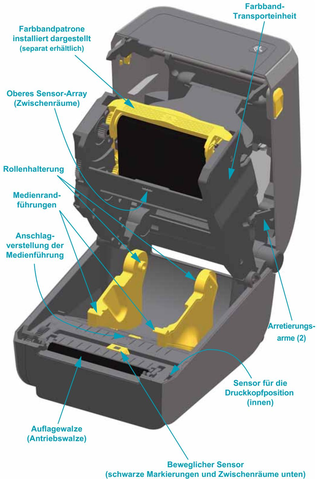
Abbildung 3 • Druckerteile (Fortsetzung)
