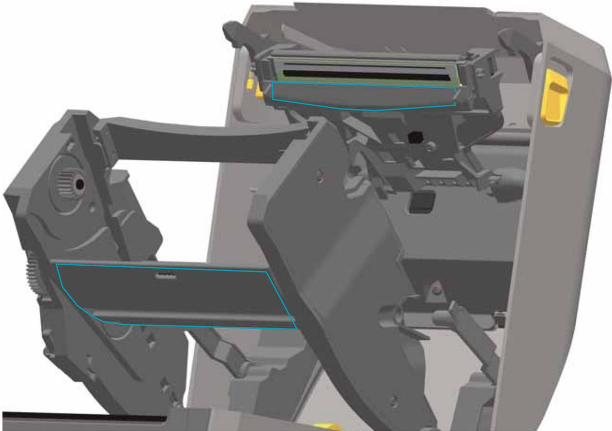
4. Wischen Sie die Innenflächen der Rollenhalterungen und die Unterseite der Medienführungen mit einem Reinigungsstäbchen ab.
