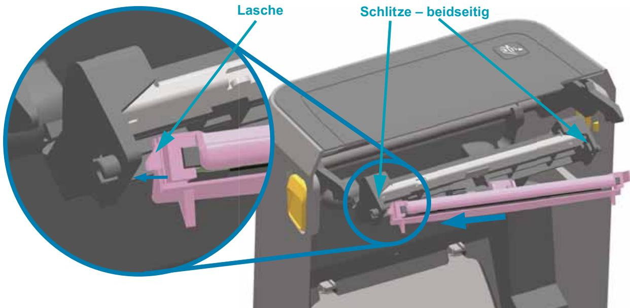
5. Drücken Sie die rechte Seite des Druckkopfes in den Drucker, bis der Hebel einrastet und der Druckkopf fest sitzt.
