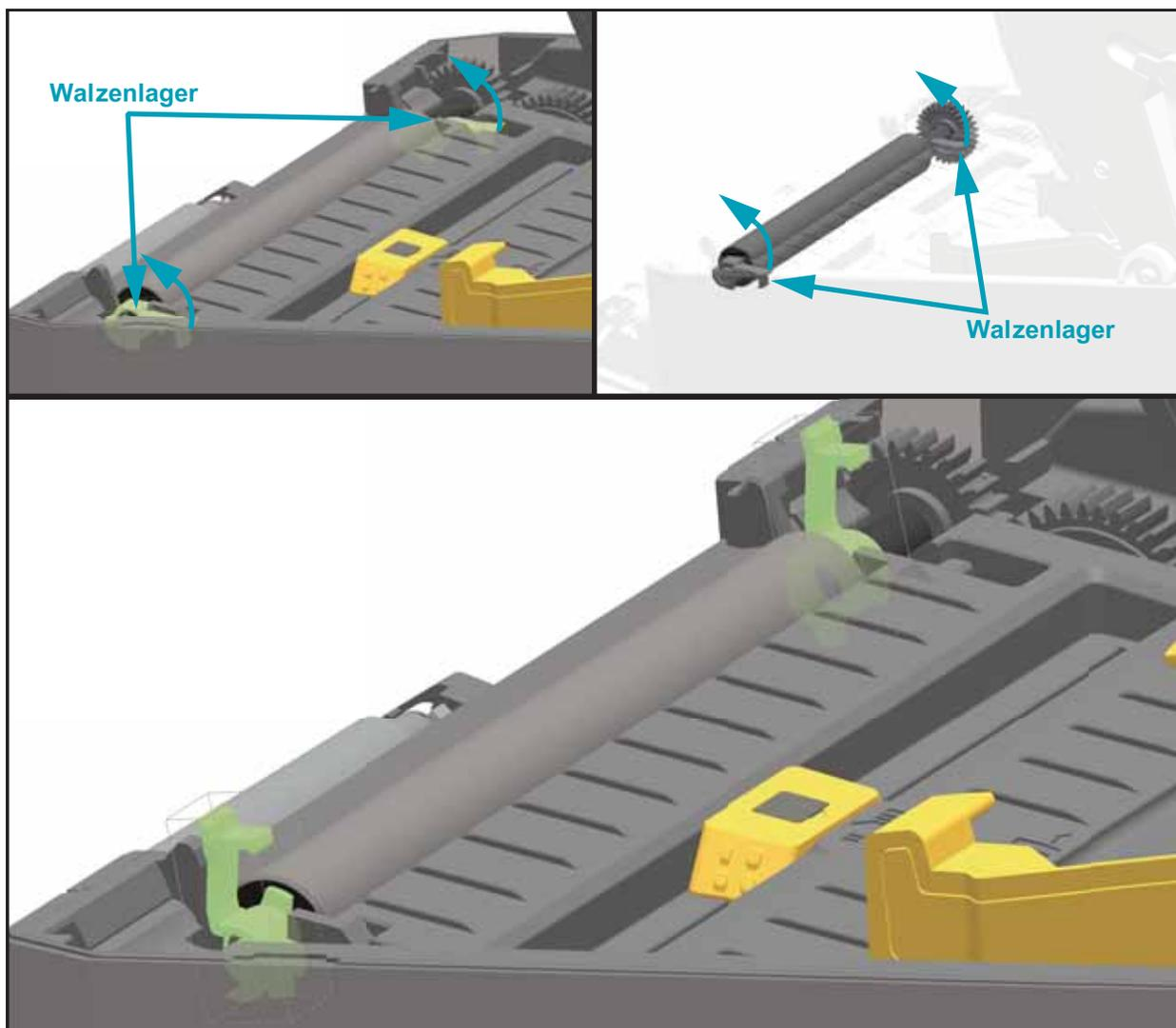
3. Heben Sie die Auflagewalze aus dem unteren Druckerrahmen heraus.
