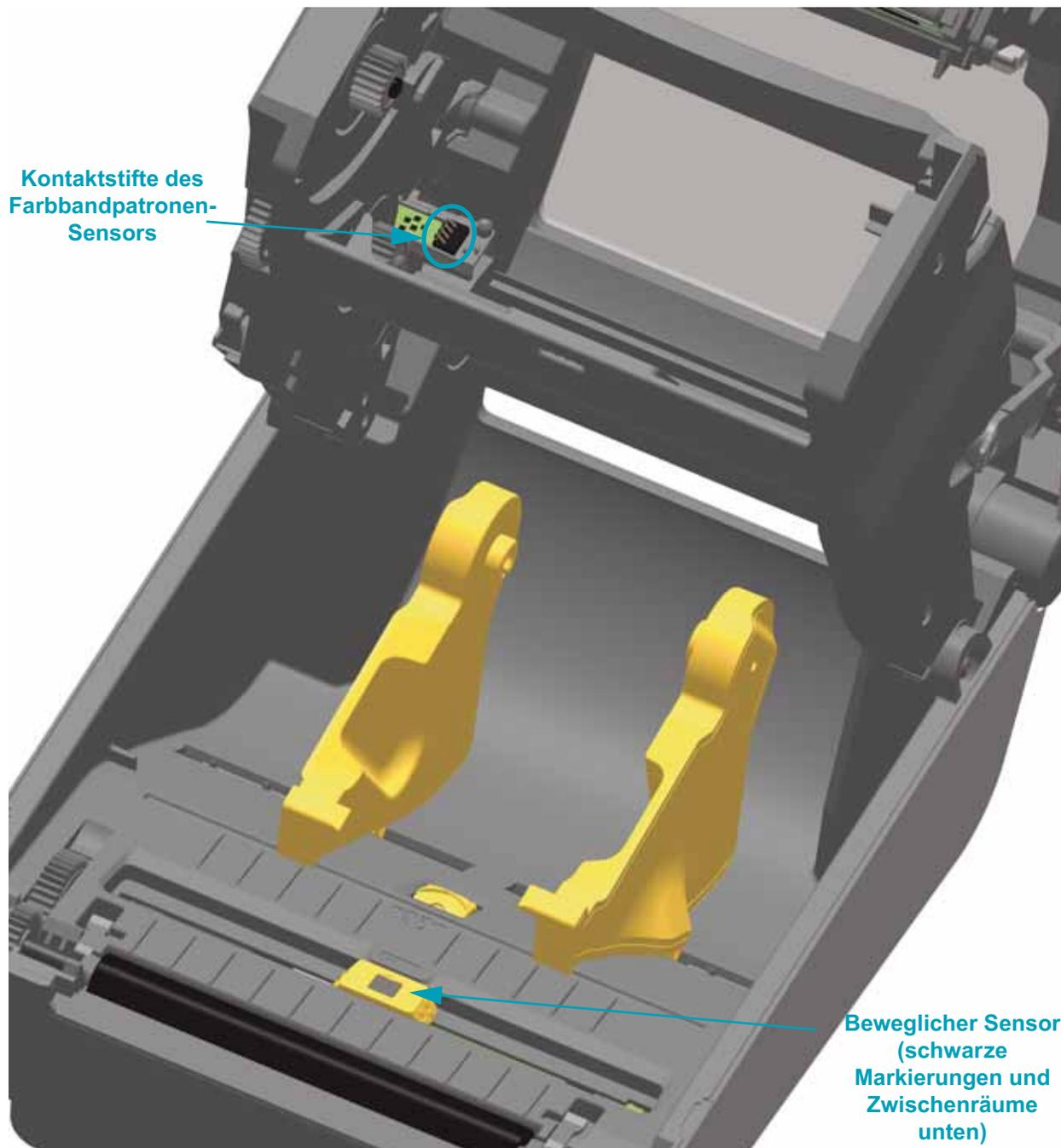
7. **Kontaktstifte des Farbbandpatronen-Sensors – nur reinigen, falls die Farbbandpatrone nicht erkannt wird.** Reinigen Sie die Kontaktstifte des Farbbandpatronen-Sensors durch leichtes Abwischen von rechts nach links. Durch ein Abwischen nach oben und unten könnten die Kontaktstifte beschädigt werden.
