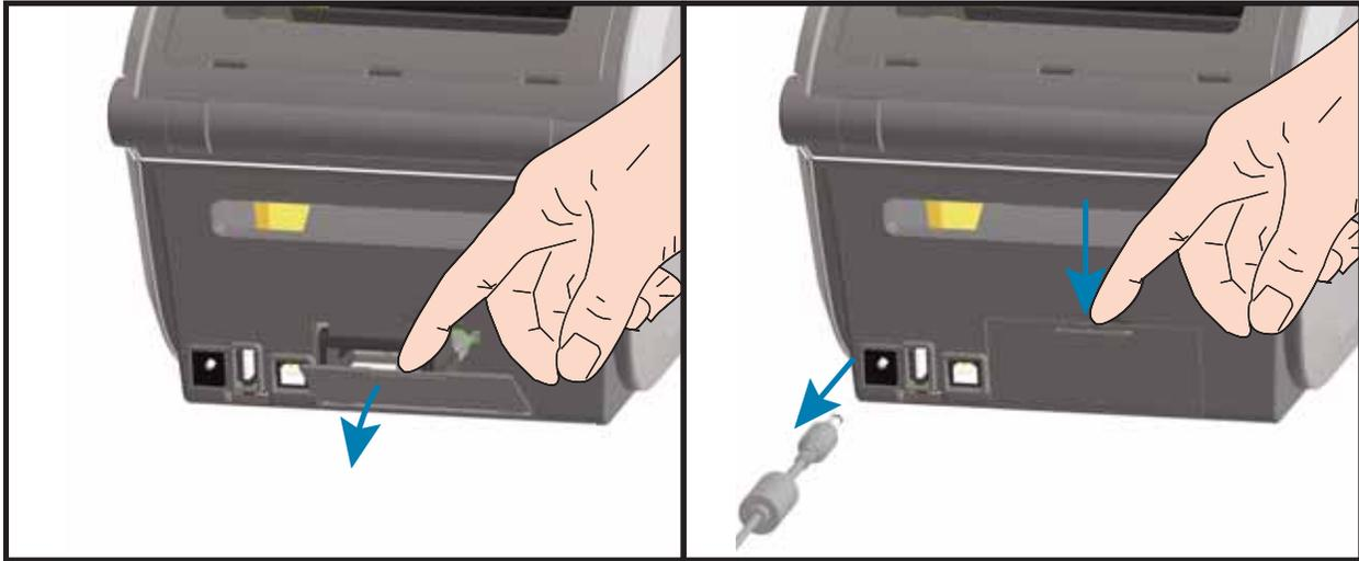
1. Schieben Sie nach dem Entfernen der Zugriffsklappe das Ethernet-Modul in den Drucker. Schieben Sie die Bus-Leiterplatte langsam, aber mit Druck in das Gerät, bis die Leiterplatte am Innenrand der Zugriffsöffnung anliegt.
