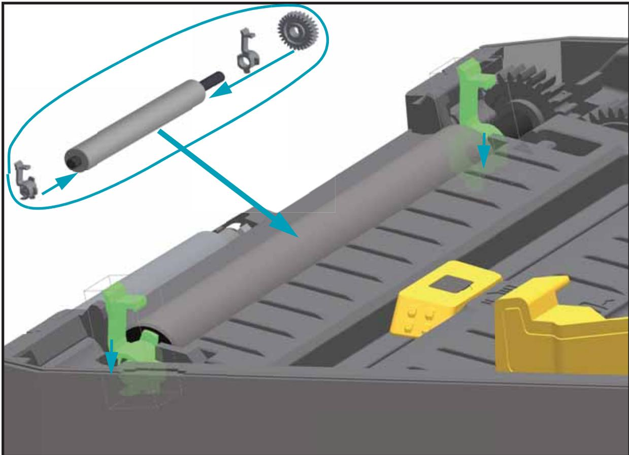
8. Halten Sie die Walze so, dass sich das Zahnrad auf der linken Seite befindet, und setzen Sie sie in den unteren Druckerrahmen ein.
