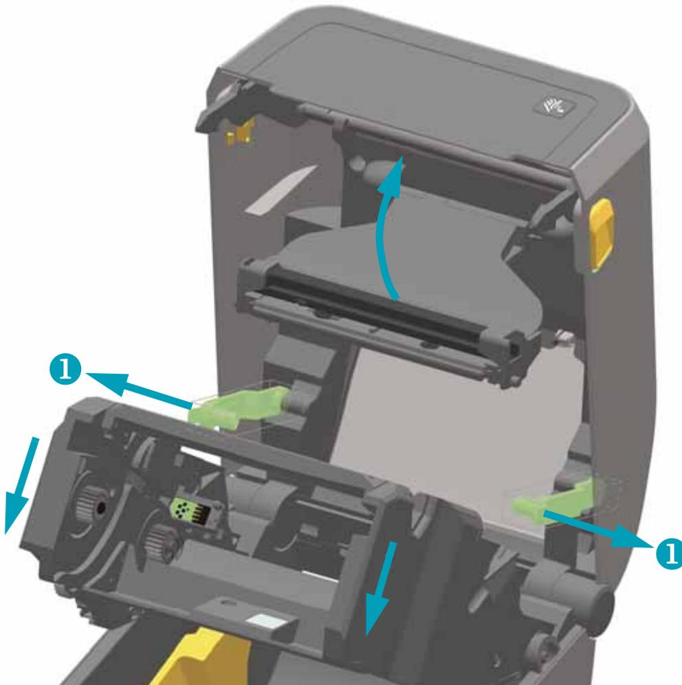
2. Schwenken Sie den Druckkopf-Auslöserarm nach oben, bis er die obere Druckerabdeckung berührt. Halten Sie den Druckkopf-Auslöserarm in dieser Position, um Zugriff auf den Bereich unter dem Druckkopf zu erhalten (siehe folgende Abbildung).
