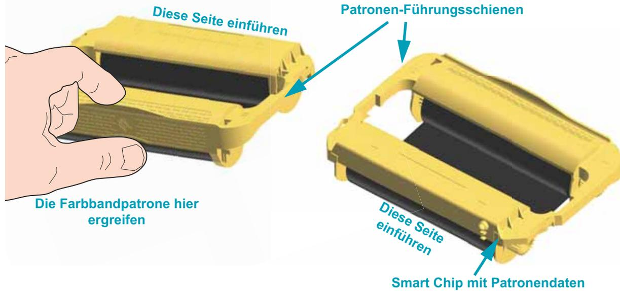
1. Führen Sie bei geöffnetem Drucker die Farbbandpatronen in den Farbbandpatronen-Schlitz der Farbband-Transporteinheit ein. Schieben Sie die Patronen ein, bis sie fast bündig mit der Vorderseite der Farbband-Transporteinheit ist. Sie hören und spüren, wie die Patrone einrastet. Es werden nur originale Zebra-Farbbandpatronen unterstützt.
