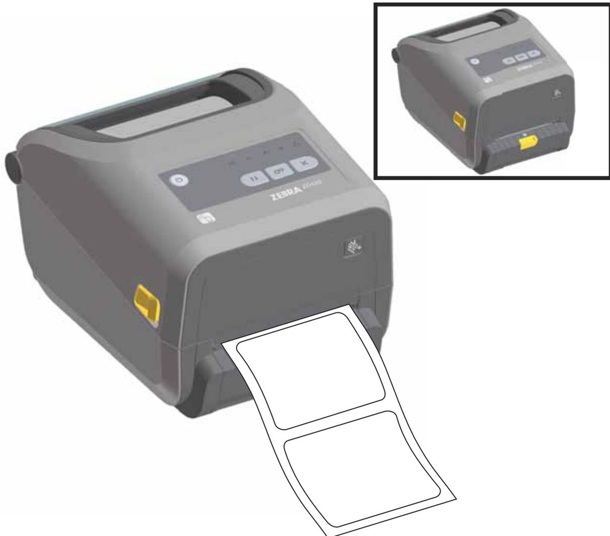
2. Ziehen Sie das Trägermaterial über die Oberseite des Druckers. Ziehen Sie am goldenen Hebel in der Mitte der Klappe des Etikettenspenders, um die Klappe zu öffnen.
