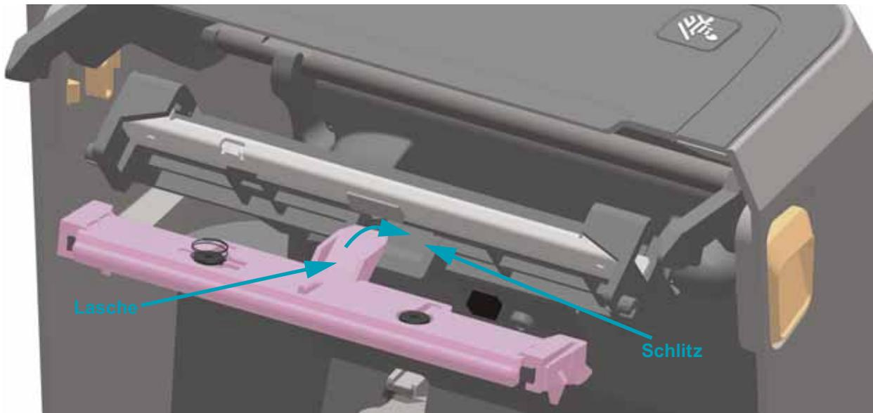
4. Führen Sie die linke Lasche der Druckkopfeinheit in den mit Aussparung versehenen Schlitz auf der linken Seite des Druckkopf-Auslöserarms ein.
