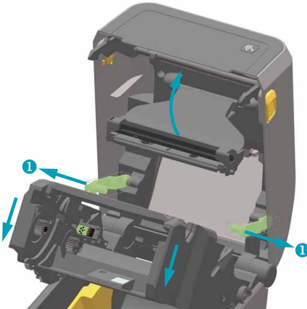
2. Schwenken Sie den Druckkopf-Auslöserarm nach oben, bis er die obere Druckerabdeckung berührt. Halten Sie den Druckkopf-Auslöserarm in dieser Position, um Zugriff auf den Druckkopf zu erhalten.
