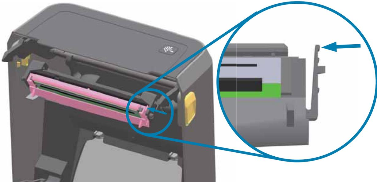
5. Drehen Sie die gelöste rechte Seite des Druckkopfes aus dem Drucker heraus. Ziehen Sie den Druckkopf etwas zur rechten Seite, um die linke Seite des Druckkopfes zu lösen. Ziehen Sie den Druckkopf nach unten und vom Druckkopf-Auslöserarm weg, um auf die angeschlossenen Kabel zugreifen zu können.
