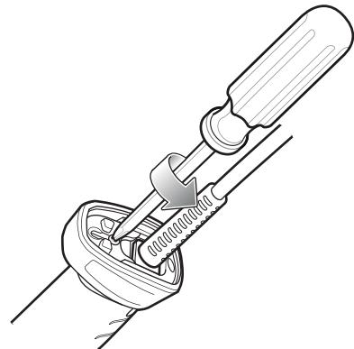
**Figure 1-3** Loosening DS3608 Lock Plate Screw
