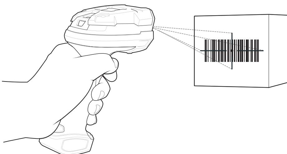
**Figure 2-3** Scanning DS3608-HP and DS3608-HD in Hand-held Mode
