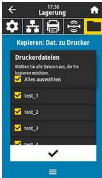
Der Drucker lädt alle ausführbaren Dateien und verarbeitet sie. Die verfügbaren Dateien werden aufgelistet. (Falls gewünscht, können Sie mit **Alles auswählen** alle verfügbaren Dateien vom USB-Flash-Laufwerk kopieren.)
