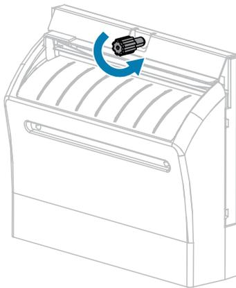
5. Entfernen Sie die Abschirmung des Schneidemoduls.
