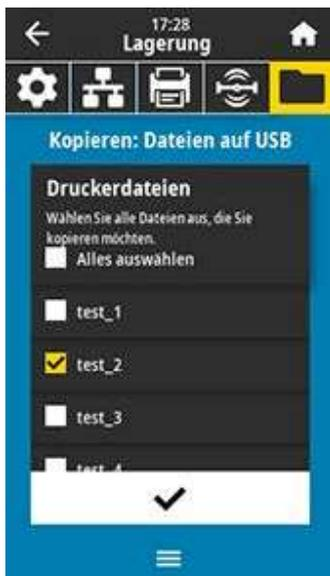
Die Option **ALLES AUSWÄHLEN** ist verfügbar, um alle verfügbaren Dateien vom Drucker auf dem USB-Flash-Laufwerk zu speichern. Jede kopierte ZPL-Datei wird nachbearbeitet, sodass der Inhalt der Datei für die normale Ausführung an einen Drucker gesendet werden kann.
