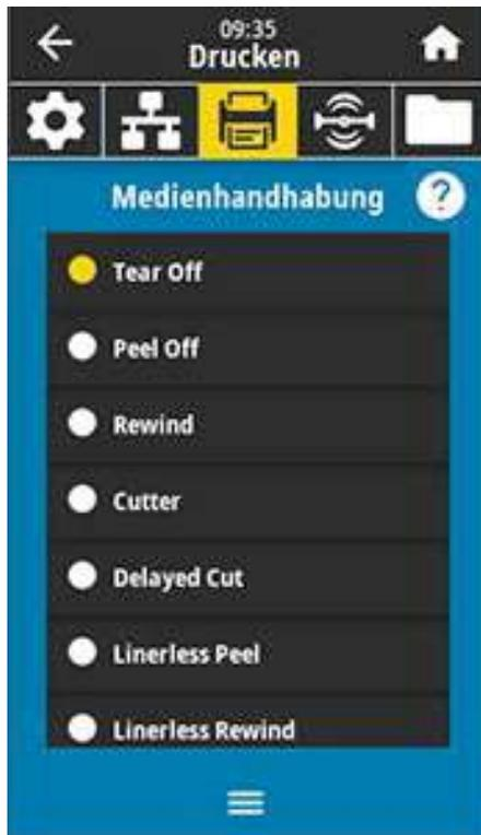
2. Wählen Sie eine Methode aus, die den verwendeten Medien und den verfügbaren Druckeroptionen entspricht.
