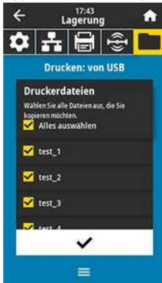
Der Drucker lädt alle ausführbaren Dateien und verarbeitet sie. Die verfügbaren Dateien werden aufgelistet. **ALLES AUSWÄHLEN** ist verfügbar, um alle Dateien auf dem USB-Flash-Laufwerk zu drucken.
