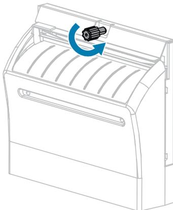
5. Entfernen Sie die Abschirmung des Schneidemoduls.
