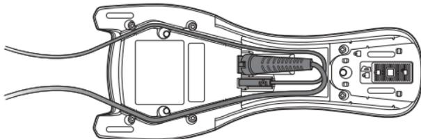
Stellen Sie beim Führen der Kabel durch die Oberseite der Basis sicher, dass Sie die Kabel vor der Positionierung in den Kabelkanälen gekreuzt haben. Andernfalls werden die Kabelverbindungen übermäßig beansprucht.
