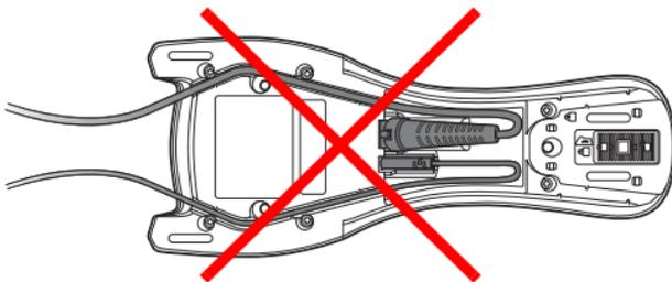
Bei der Installation auf einer vertikalen Oberfläche wird der Scanner in stehender Position über ein Verriegelungssystem gesichert. Bei der Installation auf einer horizontalen Oberfläche muss der Verriegelungsmechanismus entsperrt (nach oben gedrückt) werden. Bei der Installation auf einer vertikalen Oberfläche muss der Verriegelungsmechanismus gesperrt (nach unten gedrückt) werden.
