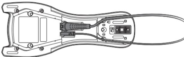
Die Kabel können ebenfalls durch die Oberseite der Basis über Kreuz nach oben geführt und dabei in den Kabelkanälen gesichert werden.
