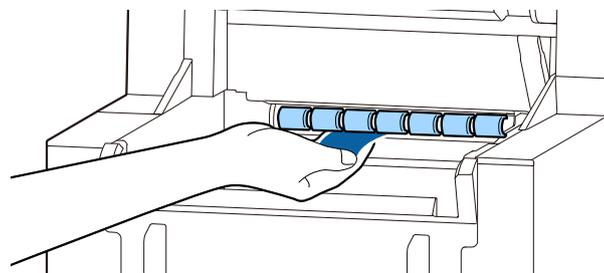
**7 Drehen Sie die Rolle von Hand, und entfernen Sie Papierstaub oder Klebstoff von der gesamten Walzenoberfläche.**
