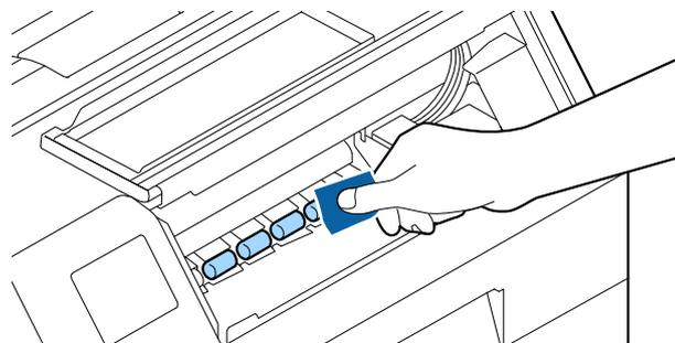
**7 Drehen Sie die Rolle von Hand, und entfernen Sie Papierstaub oder Klebstoff von der gesamten Walzenoberfläche.**
