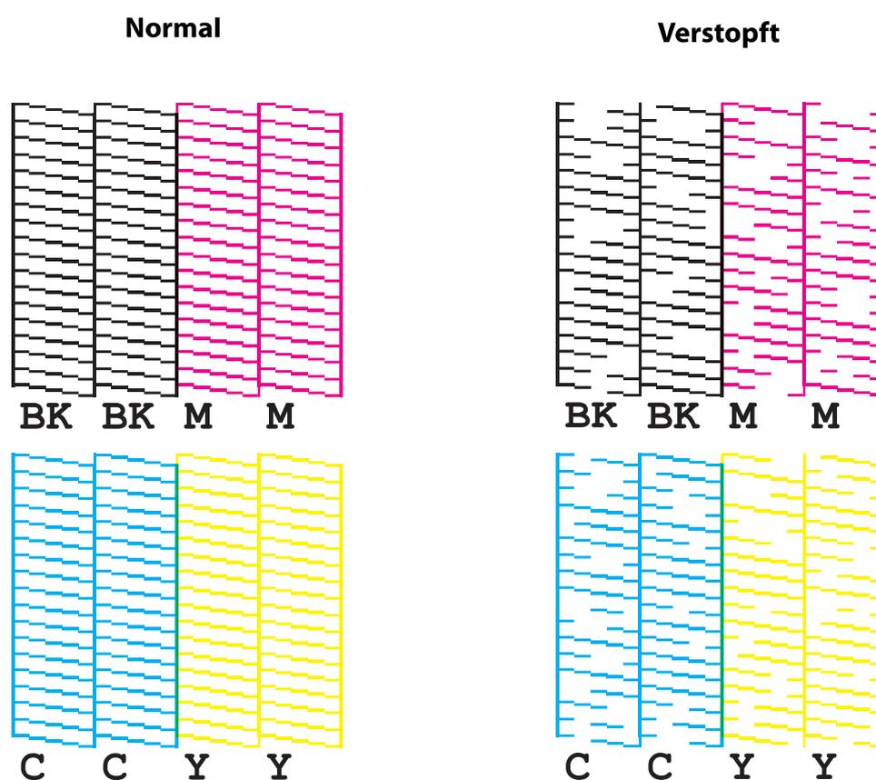
Wenn die Düsen verstopft sind, führen Sie eine Druckkopfreinigung durch. Gehen Sie wie folgt vor, um eine Druckkopfreinigung durchzuführen.
