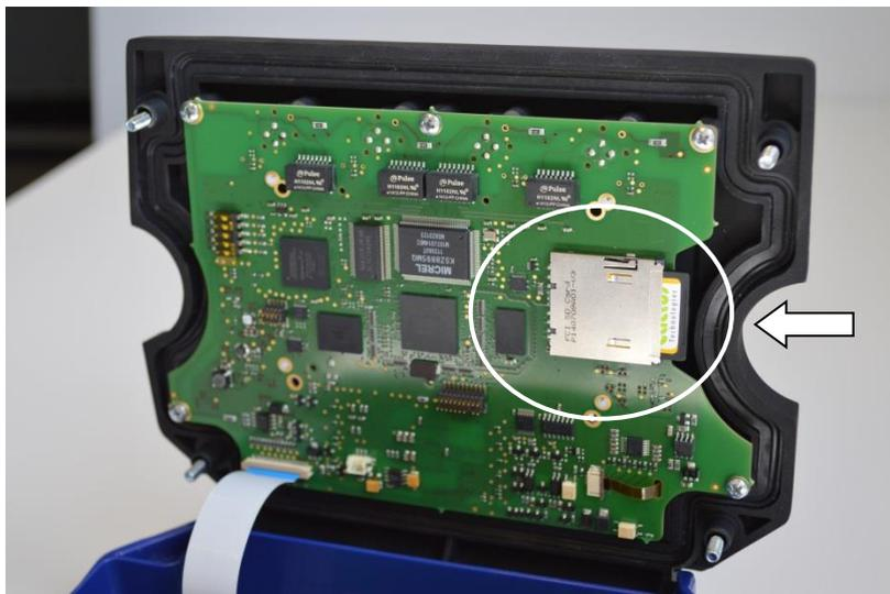
Abb. 26 – CompactFlash-Karte entfernen
