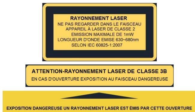
Abb. 2: Beispiele für Laserwarnaufkleber
