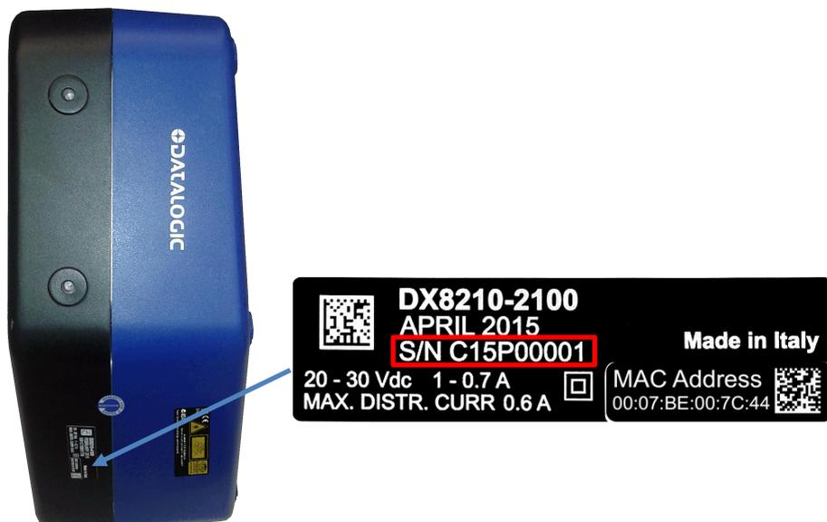
Abb. 86: Position des Seriennummertiketts
