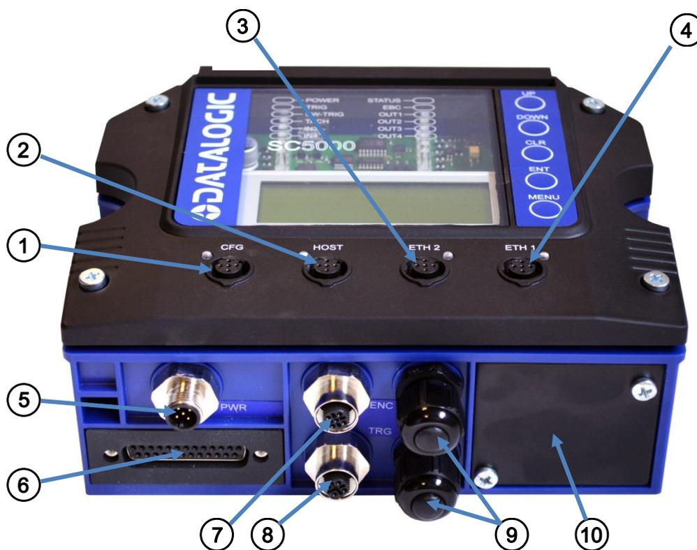
Abb. 35: Anschlussfeld eines SC5000 Controllers (Standardmodell)
