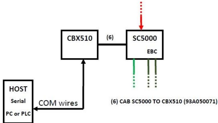
Abb. 54 – Großes synchronisiertes Netzwerk mit COM-zu-Host-Verbindung
