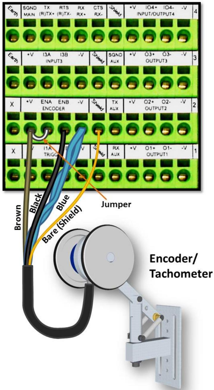
Abb. 29: Kabelanschlüsse Drehgeber OEK-4 (95B082050) (NPN-Ausgang)
