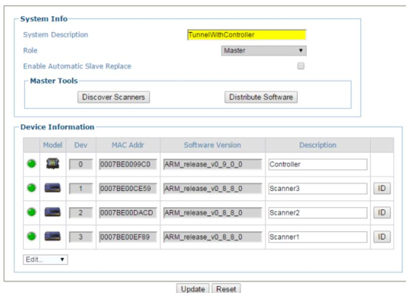
11. Falls Sie **Master** auswählen, wird das System gepolt, und die anderen Scanner werden der Liste **Device Information** (Geräteinformationen) hinzugefügt. Der SC5000 dient bei Verwendung immer als Master.
