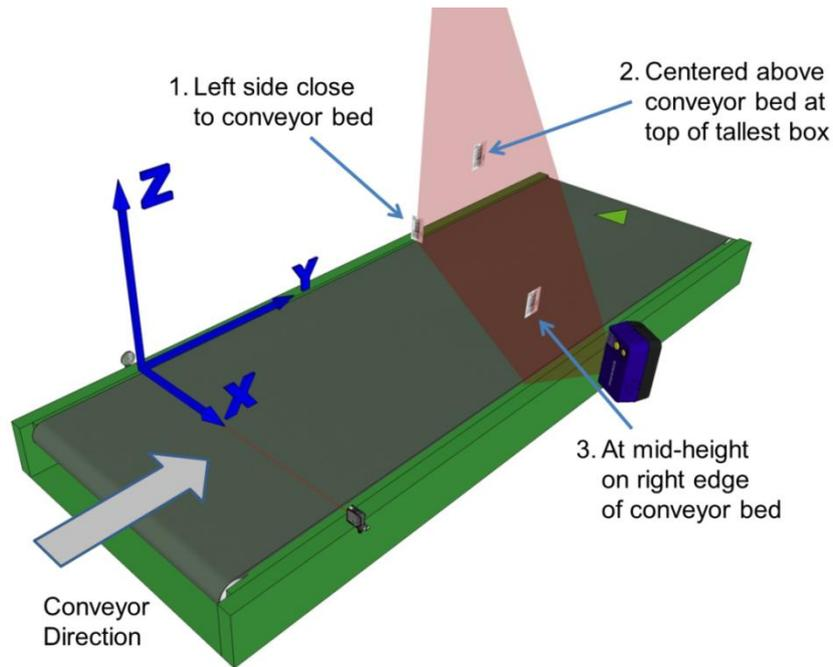
Abb. 44: Barcode-Positionen bei oben und seitlich angebrachten Barcode-Scannern
