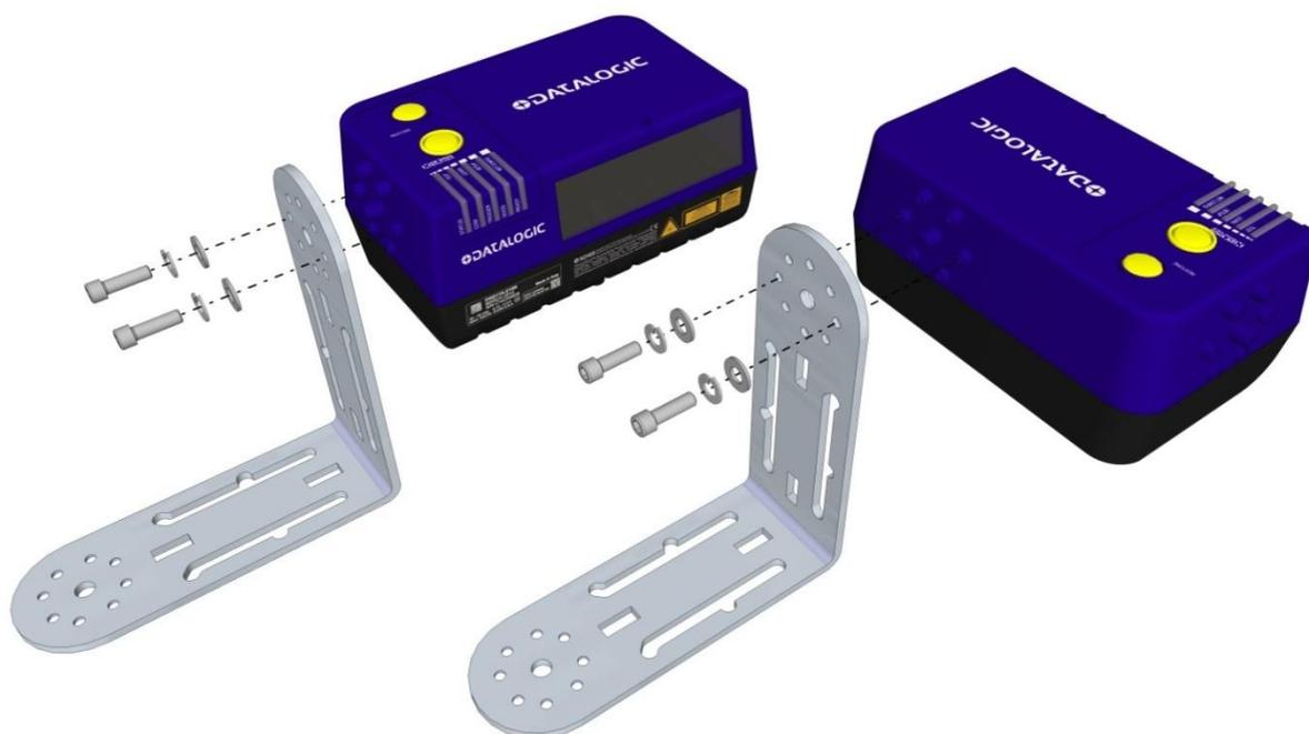
Abb. 15: Montage des Befestigungswinkels am DS8110 mit Kopfschrauben, Federringen und Unterlegscheiben
