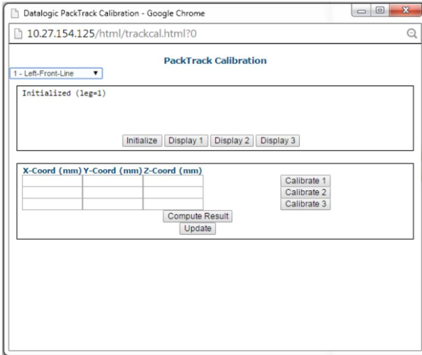
Der PackTrack-Kalibrierungsassistent fordert Sie nun auf, die Barcode-Koordinaten für die Extremwerte Ihres Scannersystems manuell zu messen und einzugeben. Messen Sie dazu die X-, Y- und Z-Koordinaten an drei verschiedenen Stellen entlang jedem einzelnen Laserstrahl der einzelnen Systemscanner, so wie in den beiden folgenden Abbildungen für oben und seitlich angebrachte Scanner dargestellt.
