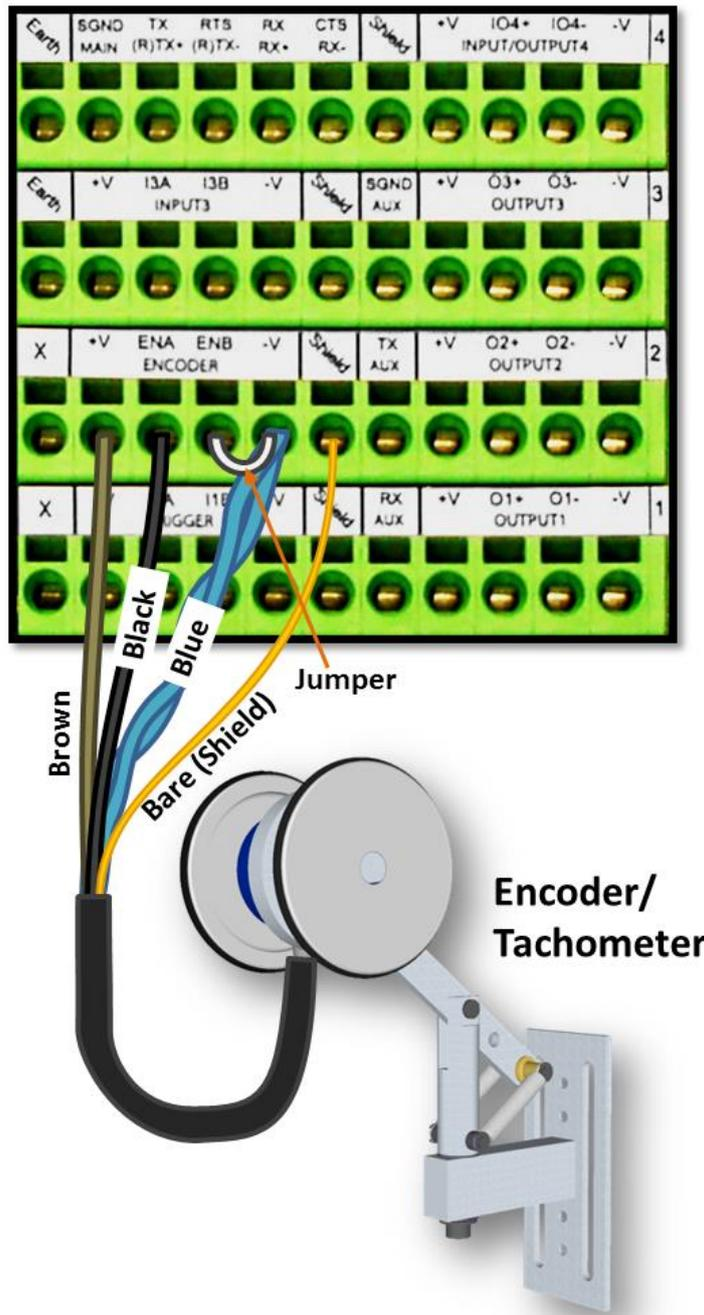
Abb. 31: Kabelanschlüsse Drehgeber OEK-4 (95B082050) (PNP-Ausgang)
