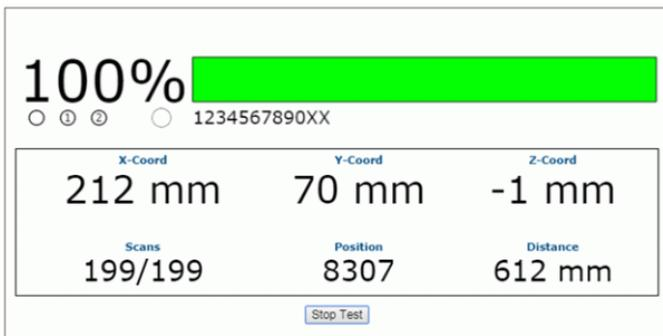
4. Messen Sie manuell die Koordinaten X (vom linken Förderbandrand), Y (von der Sensorlinie) und Z (Codehöhe von der Förderbandoberfläche) des Testcodes und vergleichen Sie diese Messwerte mit den im Fenster **Read Test** angezeigten Ergebnissen. Ihre Messwerte und die angezeigten Ergebnisse sollten annähernd übereinstimmen. Eine exakte Übereinstimmung ist nicht notwendig, solange sich die Toleranzen im Millimeterbereich bewegen.
