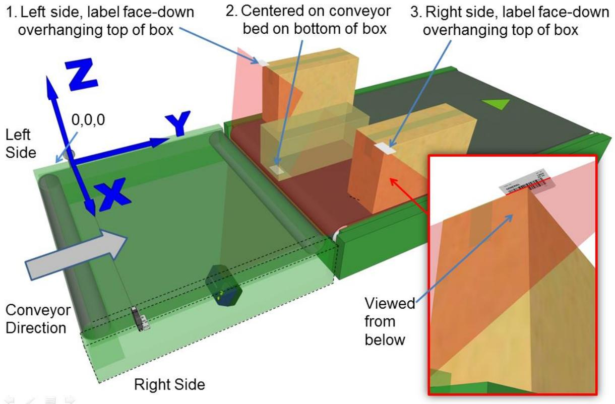
Wie bereits bei den Beispielen für oberhalb und seitlich montierte Scanner müssen Sie auch diesmal die X-, Y- und Z-Koordinaten aller drei Barcodes messen und in den PackTrack-Assistenten eingeben.
