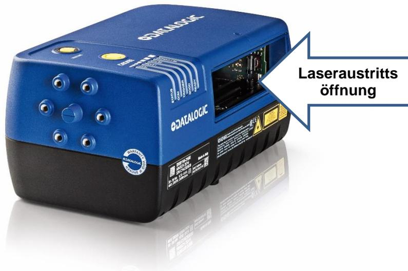
Abb. 71: Position des Laserstrahlaustrittsfensters
