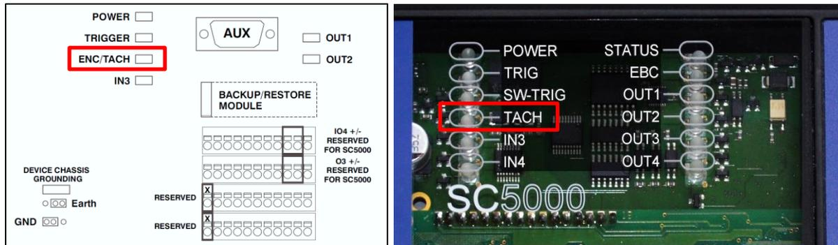
Abb. 73: LED-Anzeigen ENC/TACH LED der CBX510 Anschlussbox und SC5000 Controller
