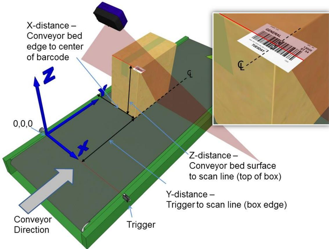
Abb. 46: Platzierung des zweiten Barcodes bei oberhalb montiertem Scanner
