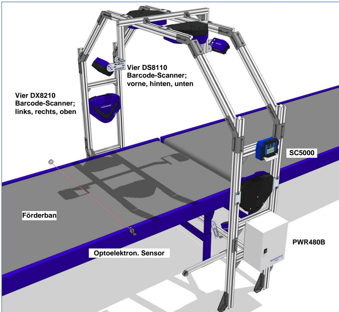
Abb. 55 – Beispiel für eine ATR Lesestation mit großem synchronisiertem Netzwerk
