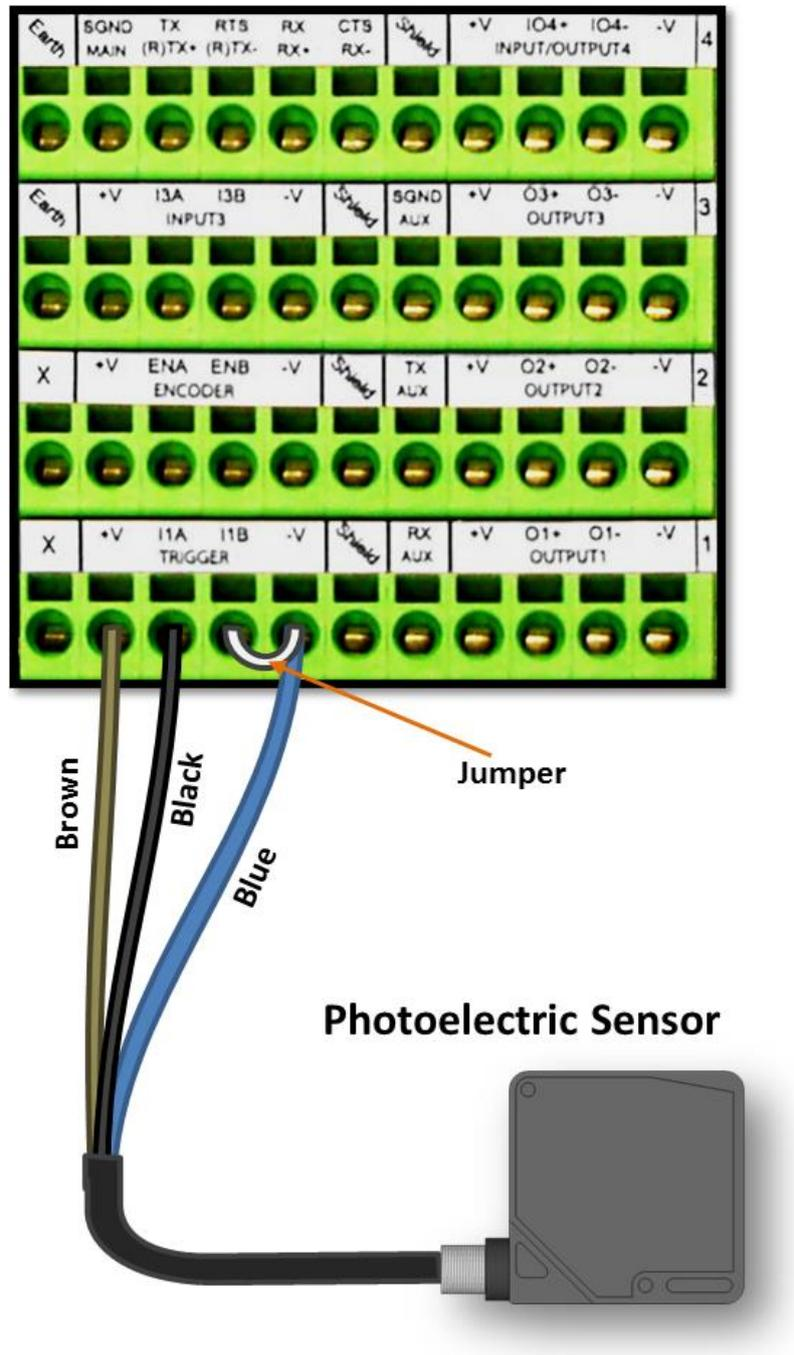
Abb. 27: Kabelanschlüsse des optoelektronischen Sensors (PNP-Ausgang)
