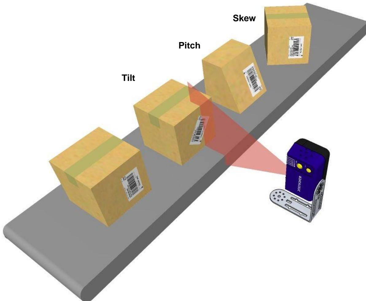
Abb. 18: Kippwinkel (Pitch), Drehwinkel (Skew) und Azimutwinkel (Tilt)
