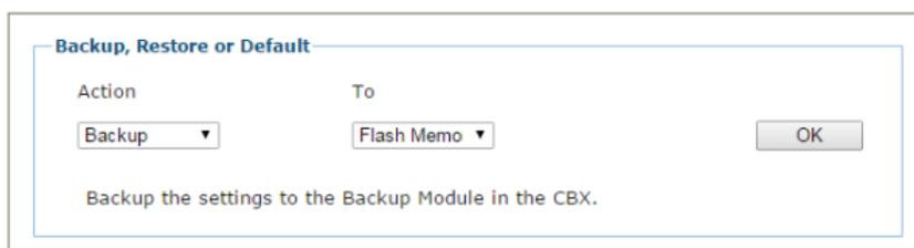
20. Wählen Sie aus der Drop-down-Liste unter **Action** (Aktion) die Option **Backup** (Sichern) und unter **To** (An) die Option **Flash Memory** (Flash-Speicher) aus.
