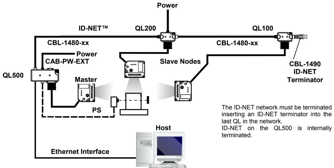
**ID-NET<sup>TM</sup> M/S Synchronized Layout with QL500 TCP/IP Ethernet Interface to Host**
