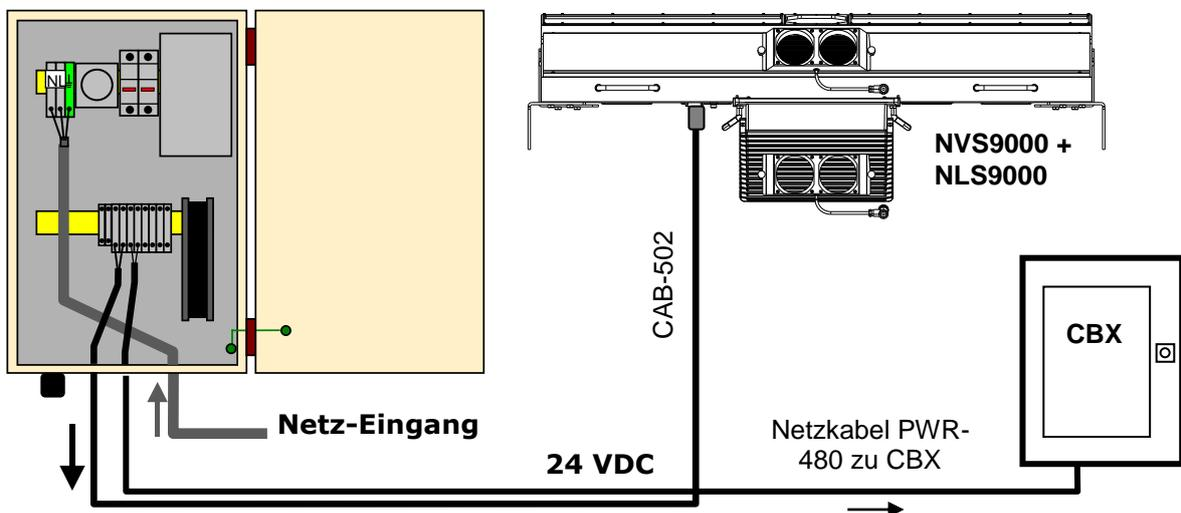
Abb. 11 – Anschluss der PWR-480B an NLS9000 Beleuchtung
