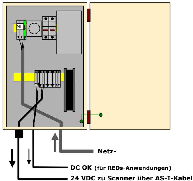
Abb. 7 – Direktanschluss der PWR-480B an Scanner
