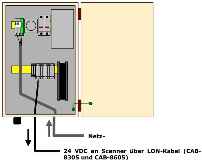
Abb. 12 – Direktanschluss der PWR-480B an LON-Scanner
