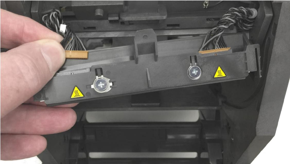
3. Führen Sie die mittlere Lasche der Druckkopfeinheit in den mittleren Schlitz auf dem Druckkopf-Auslöserarm ein.
