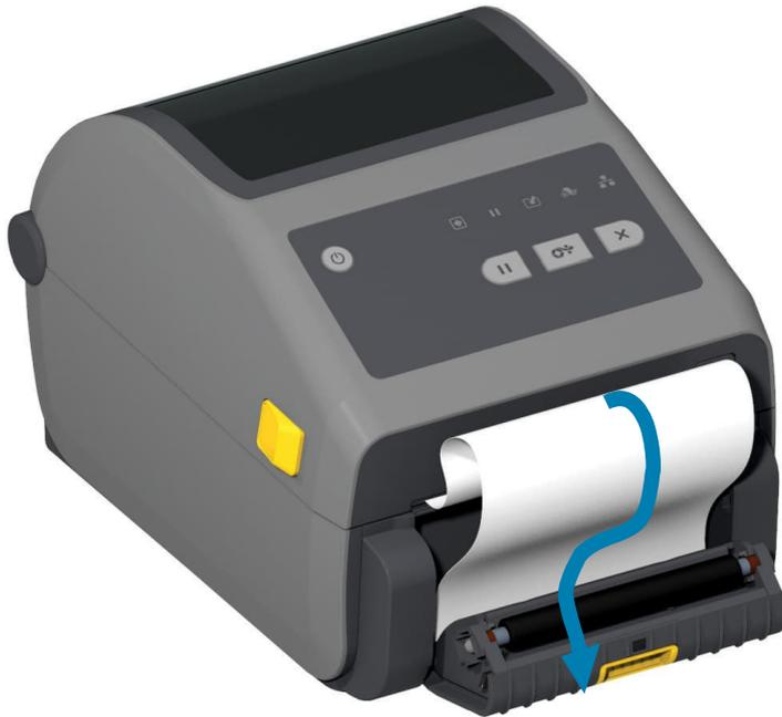
4. Schließen Sie die Klappe des Etikettenspenders, und ziehen Sie das Ende des Trägermaterials straff.
