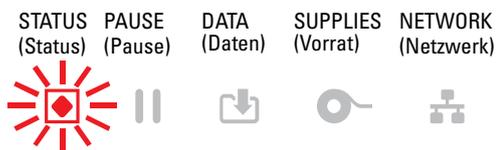
Der Drucker kann den Druckauflösungstyp (dpi) des Druckkopfs nicht lesen. Der Druckkopf wurde nicht korrekt ausgetauscht oder durch einen Druckkopf eines anderen Herstellers ersetzt.
