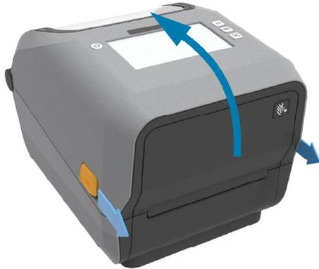
2. Öffnen Sie die Medienrollenhalterungen. Richten Sie die Medienrolle so aus, dass die zu bedruckende Seite beim Laufen über die Auflagewalze (Antriebswalze) nach oben zeigt. Ziehen Sie die Medienführungen mit der Hand auseinander, setzen Sie die Medienrolle auf die Rollenhalterung, und lassen Sie die Führungen wieder los. Überprüfen Sie, ob sich die Rolle frei drehen lässt. Die Rolle darf nicht im Medienfach aufliegen.
