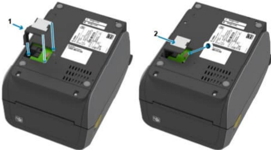
7. Richten Sie die kürzeste Seite der Klappe für drahtlose Verbindungen (1) an der kürzesten Seite der Öffnung aus.
