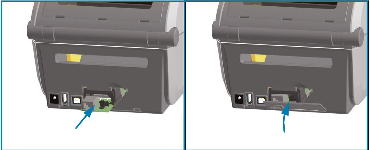
1. Schieben Sie nach dem Abziehen des Gleichstromnetzsteckers und Entfernen der Zugriffsklappe das Ethernet-Modul in den Drucker.
