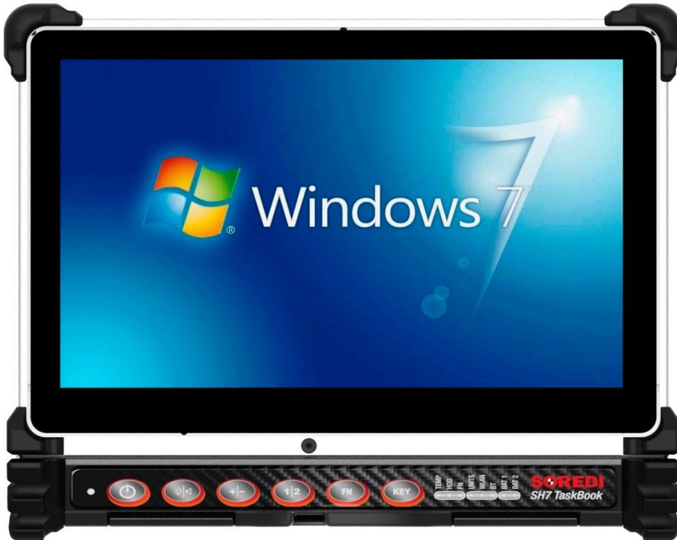
Bei dem SH TaskBook handelt es sich um eine revolutionäre Produktreihe von modularen, mobilen Geräten mit 7“ und 10“ Multitouch-Displays hinter 1,6 mm starkem Gorillaglas, die auch mit Handschuhen bedient werden können.
