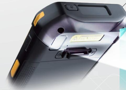
Der Akku mit Schnellverschluss spart Zeit beim Akkuwechsel
